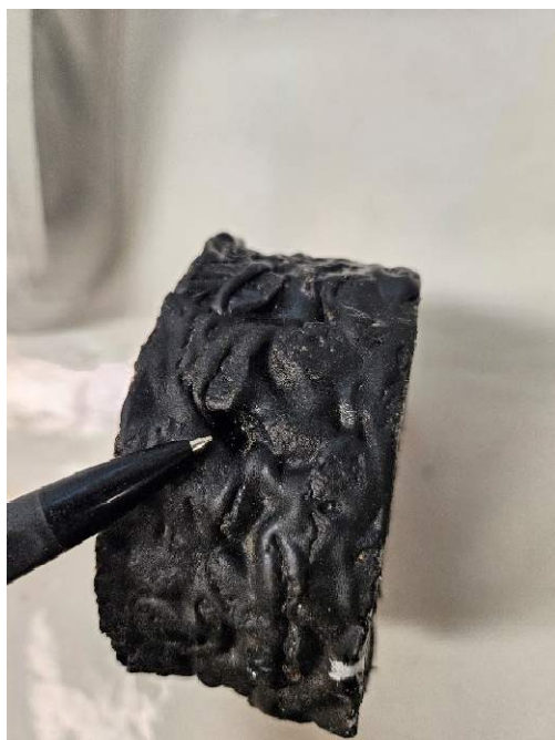
Figur 24. Hål som bildades av sensortrycket på varmlagningsprov G12 vid 20°C. Bild: Eric Gardner.
