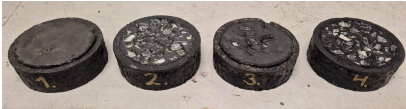
Figur 18. Varmagningsprover efter prallanalys (utförd på osågade yta). Prov 1 och 3 – toppen av tillverkade provkropp. Prov 2 och 4 – botten av tillverkade provkropp Bild: Patryk Witkiewicz.
