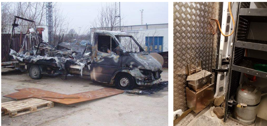
Figur 1. Nedbrunnen borbuss efter olycka med gasolflaska som används till bitumenuppvärmning (till vänster), uppvärmningsgryta med gasolflaska (till höger). Bilder: Skanska.
