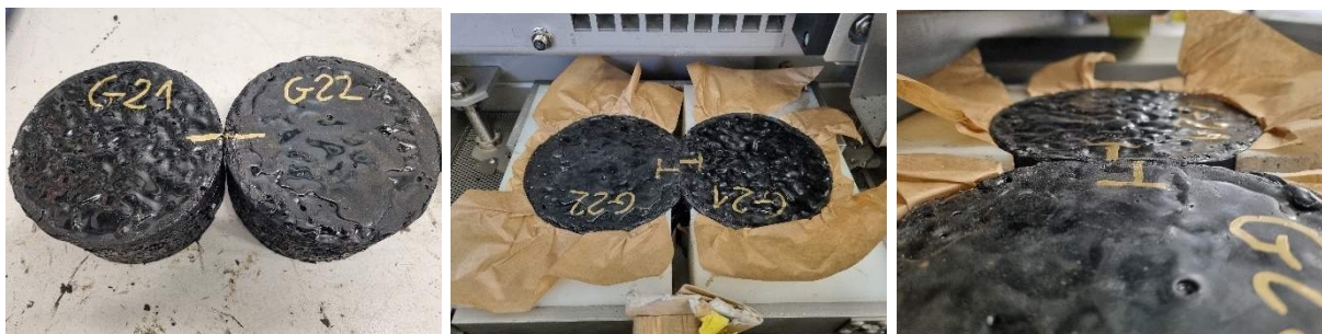
Figur 26. Förberedning av prover för Wheel tracking. Bilder: Patryk Witkiewicz.
