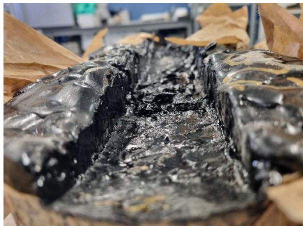
Figur 29. Varmlagningsprover efter Wheel tracktestning. Bilder: Patryk Witkiewicz.
