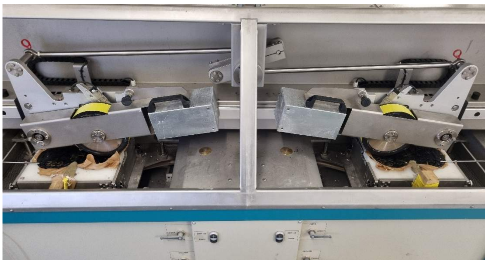
Figur 27. Prover installerade i Wheel trackingutrustningen och klara för att genomföra testet. Bild: Patryk Witkiewicz.
