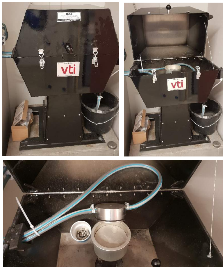
Figur 16. Utrustning för bestämning av nötningsmotstånd, Prall. Bilder: Patryk Witkiewicz.
