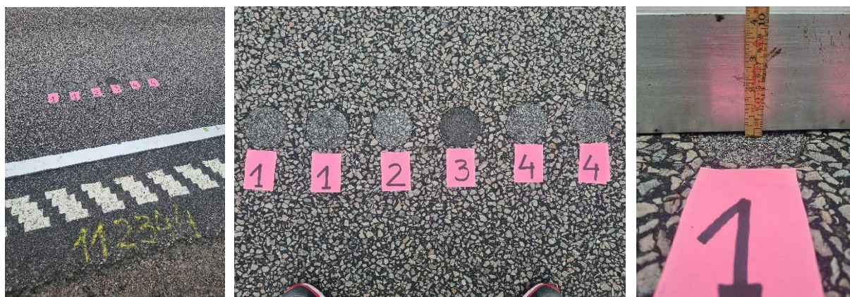
Figur 32. Dokumentering av lagningarnas skick efter 14 månader av användning. Bilder: Patryk Witkiewicz.
