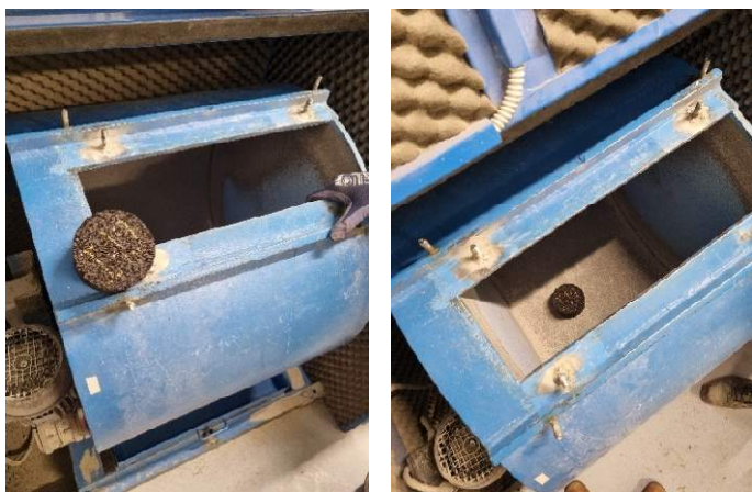
Figur 30. Prov och LA-trumman innan testning för stensläpp. Bilder: Patryk Witkiewicz.
