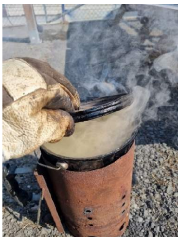
Figur 7. Rök från uppvärmt oxiderat bitumen. Bild: Patryk Witkiewicz.
